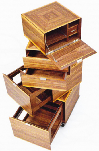
Die Tradition des mittelalterlichen Escritorio/Schreibkastens lebt. Tanzendes Büroassistentenmöbel aus edelholzturniertem Nussbaum mit Drehmechanismus, von Franz Bader, Meisterstück, Schulen für Holz und Gestaltung, Garmisch-Partenkirchen | © Wolfgang Pulver, Fotograf / Franz Bader / DVA (aus dem Buch „Möbel im Detail“, siehe S. 26)
